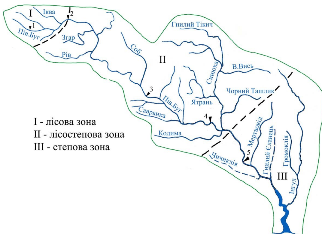
Рисунок 3.9 – Схема басейну річки Південний Буг та розташування основних гідрологічних постів на її руслі (нумерація постів відповідає таблиці 3.10) [10]
